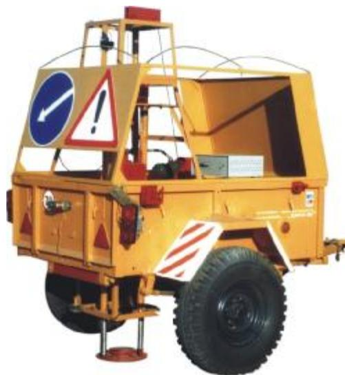
*Рис.5. Установка динамического нагружения «Дина-3М»*
