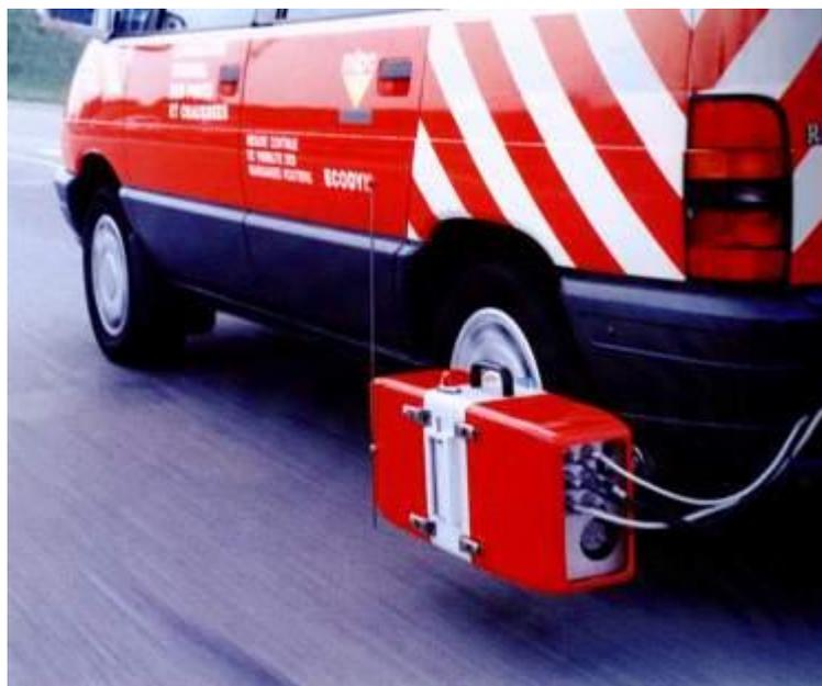
*Рис.25. Прибор контроля качества разметки ECODYN*
