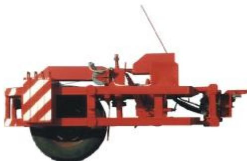
*Рис.4. Динамометрический прицеп ПКРС-2У*
