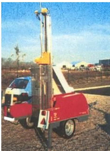
*Рис.19. Динамический пенетрометр РДГ 1000*
