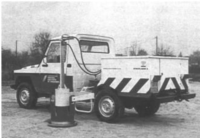
*Рис.14. Дефлектометр DYNAPLAQUE 2*
