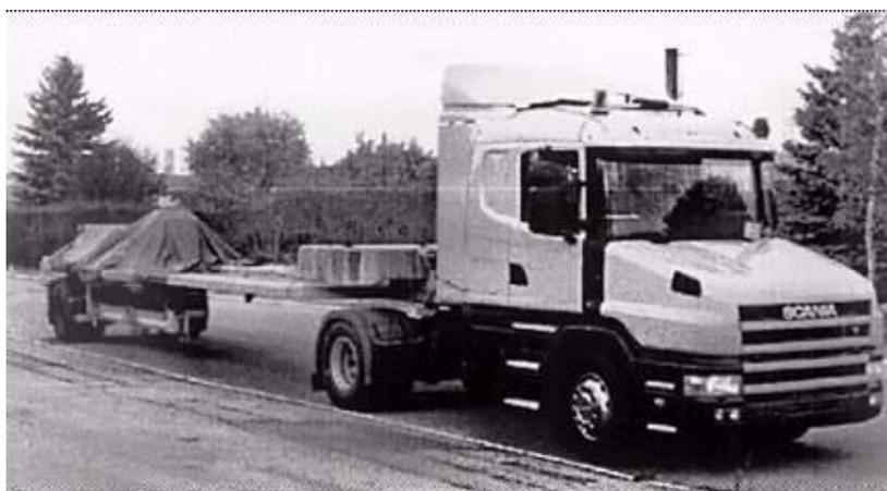
*Рис.18. Высокоскоростная установка измерения прогиба (High Speed Deflectograph)*
