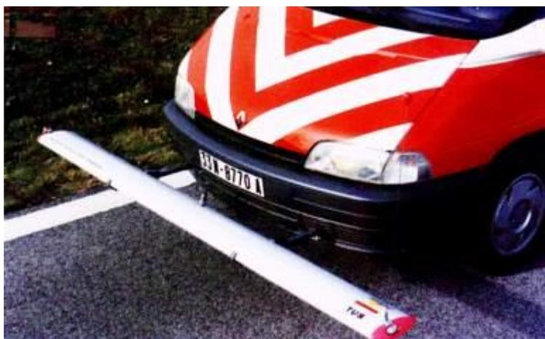
*Рис.26. Ультразвуковой профилометр TUS*
