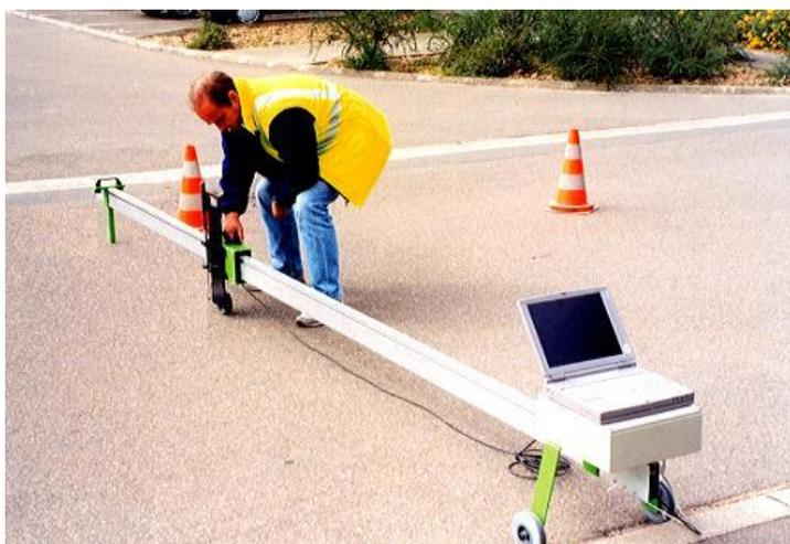
*Рис.28. Цифровой измеритель поперечного профиля VEC450*
