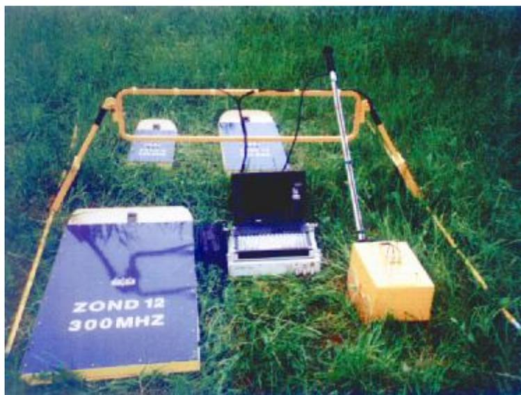
*Рис.34. Георадар (RADAR Systems Inc.)*
