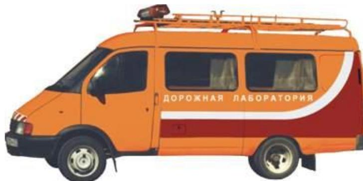
*Рис.3. Передвижная лаборатория КП-514МП на базе ГАЗ-3221 "ГАЗЕЛЬ"*
