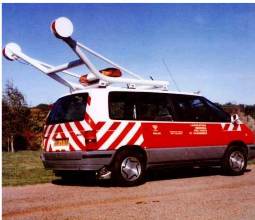
*Рис.27. Лазерный профилометр PALAS-2*
