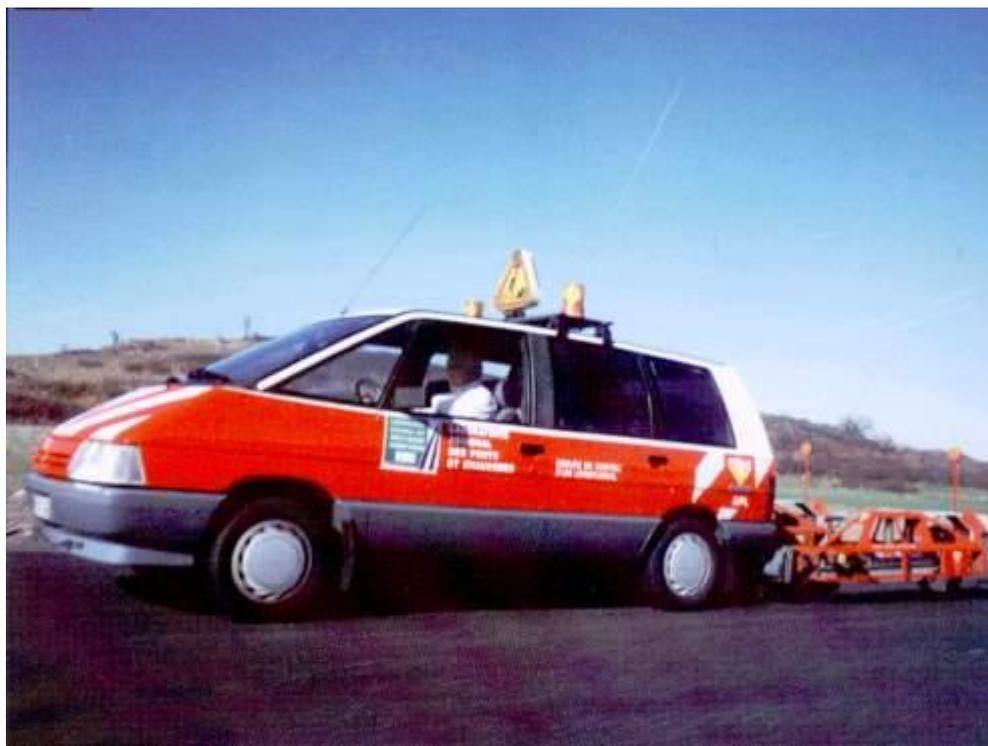
*Рис.22. Анализатор продольного профиля APL*
