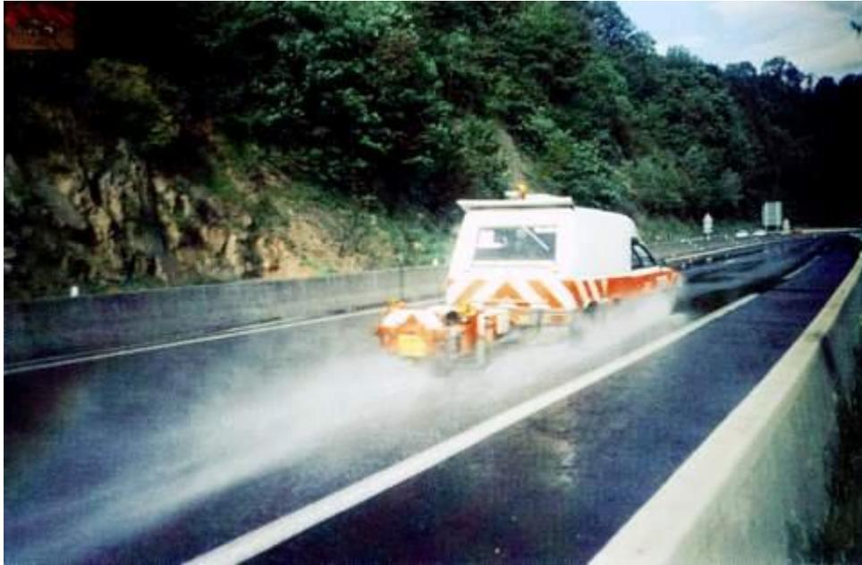
*Рис.24. Установка измерения коэффициента сцепления ADHERA*
