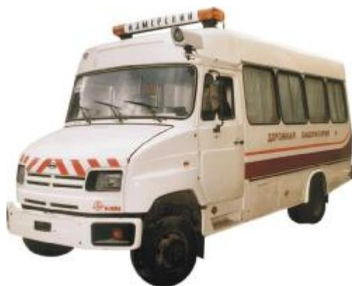
Рис.6. Передвижная лаборатория КП-514МП с системой видеосъемки
