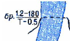
Броды: 1,2—глубина, 180—длина в метрах, Т—характер грунта (П—песчаный, Т—твердый, В—вязкий, К—каменистый), 0,5—скорость течения в м/сек
